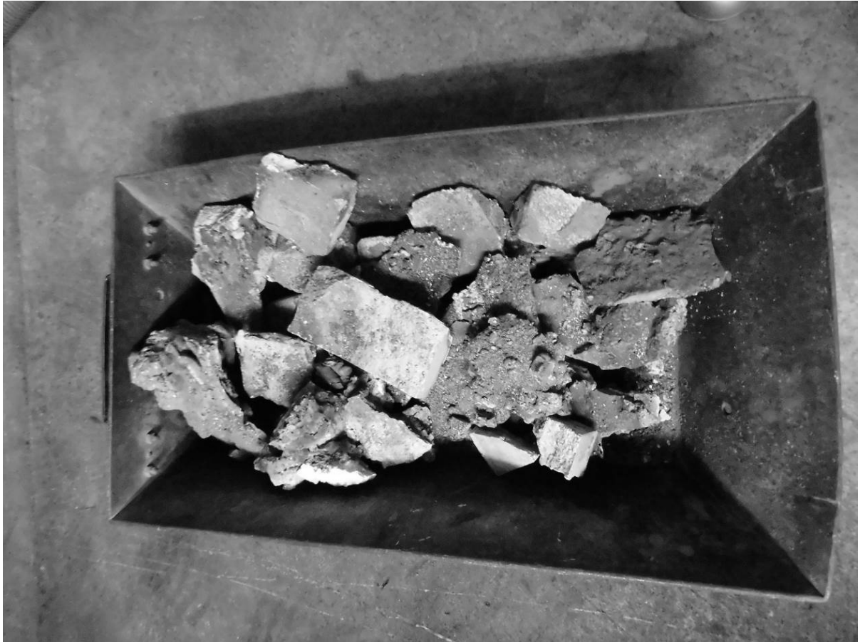
Bild 3 – Steineausbruch aus Ofen 1 (am 07.04.2015 bei Reinigungsarbeiten am Ofen entnommen)
