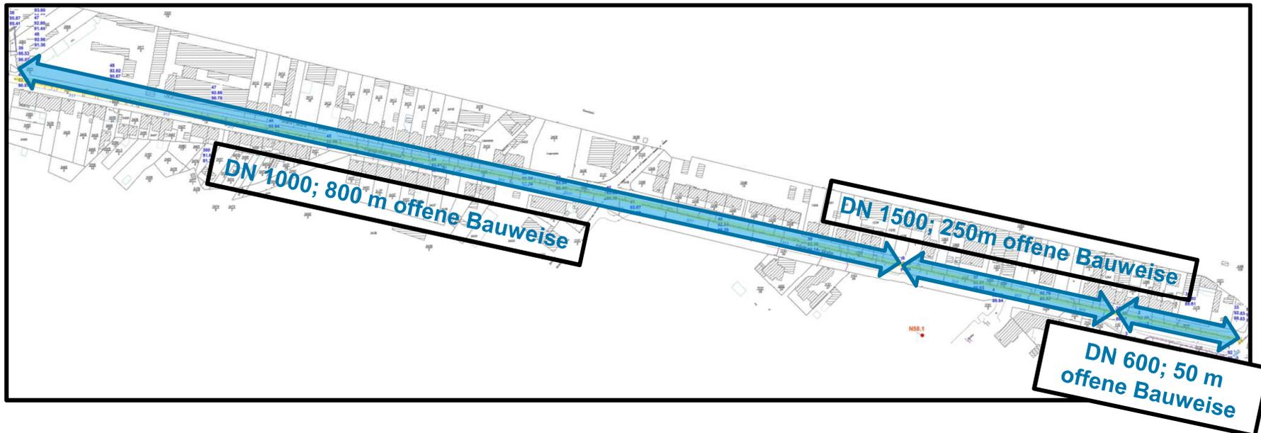
Querschnittsvergrößerung in offener Bauweise im neuen Baufeld: Rodung von 11 Platanen auf nördlicher Straßenseite im Bereich der Haltestelle Hauptfriedhof. 700 Meter des Sanierungsbereichs kann die Straßenbahn eingleisig fahren. Aus Gründen der begrenzten Länge des einspurigen Verkehrs kann nur mit 1 Kolonne gearbeitet werden. Die Bauzeit beträgt im Kanal-Gleiskonfliktbereich etwa 22 Monate. Die gesamte Maßnahme wird ca. 33 Monate dauern. SEV erfolgt in den Sommerferien.
