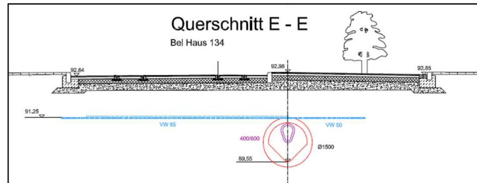
Die Lage des bestehenden Kanals ist teilweise unter bzw. nah an den Gleisen
