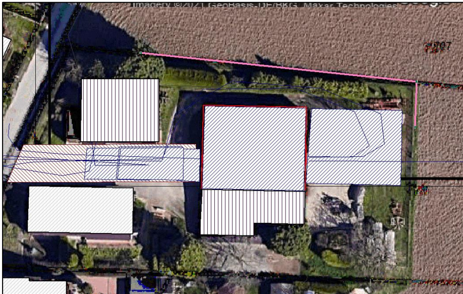
Digitales Geländemodell (Ausschnitt); Verlauf der Schallschutzmauer mit 3 m Höhe in Pink eingezeichnet; Quelle: ebenda, S. 24
