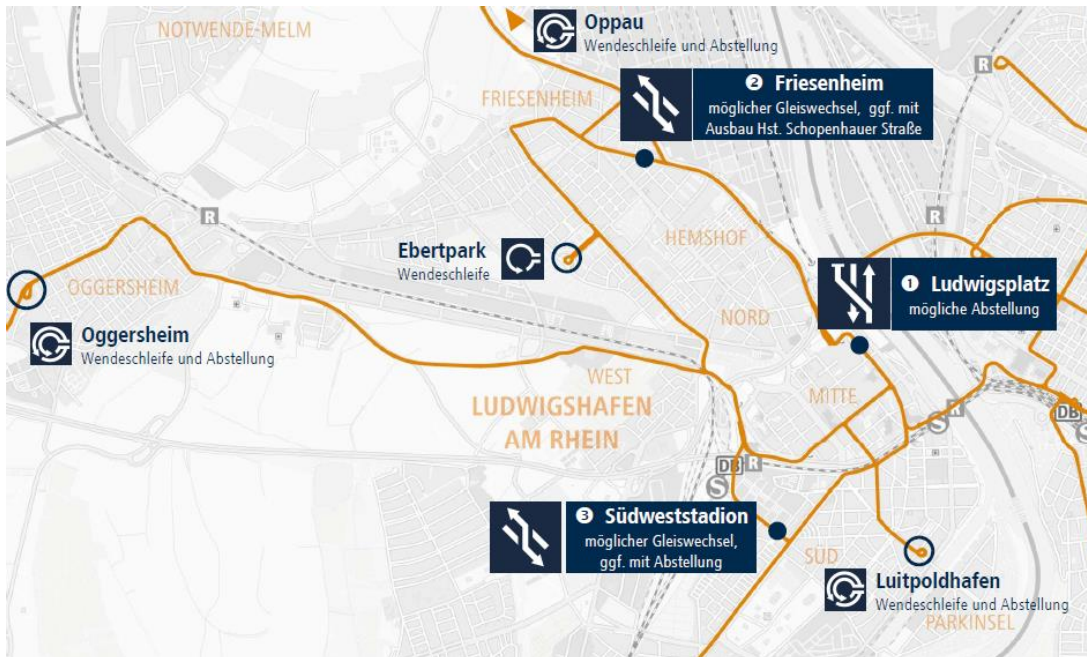
Abbildung 14: Mögliche Weichenverbindung für „Kurzwenden“ mit Zweirichtungsfahrzeugen
