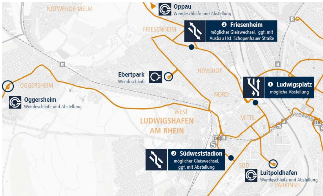
Abbildung 14: Mögliche Weichenverbindung für „Kurzwenden“ mit Zweirichtungsfahrzeugen
