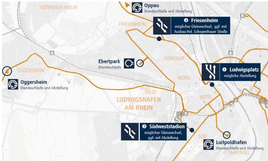
Abbildung 12: Mögliche Weichenverbindung für „Kurzweiden“ mit Zweirichtungsfahrzeugen
