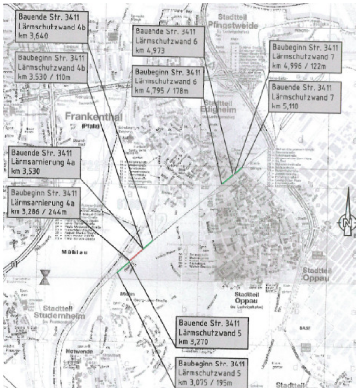
Abbildung 14: Lärmschutzmaßnahmen Zufahrt KVT
