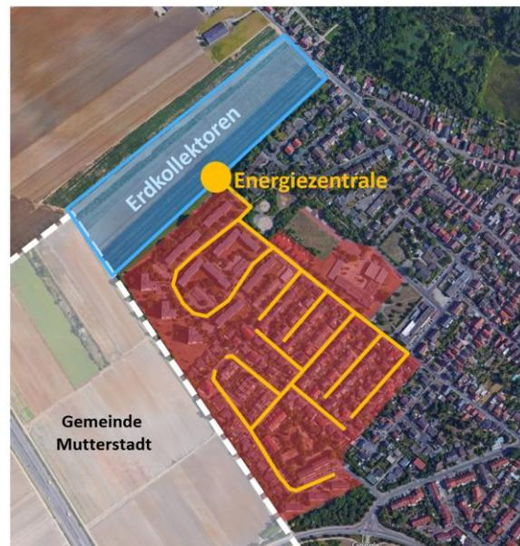
Abbildung 58: Beispielhaftes Nahwärmekonzept mit einer zentralen Wärmeerzeugung mittels Erdkollektor-Wärmepumpe und einem Wärmenetz.
