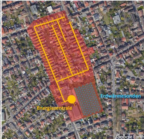
Abbildung 55: Beispielhaftes Nahwärmekonzept mit Nutzung des Sportplatzes als Geothermiequelle (Sportplatz nach Einbringung der Erdsonden wieder nutzbar).
