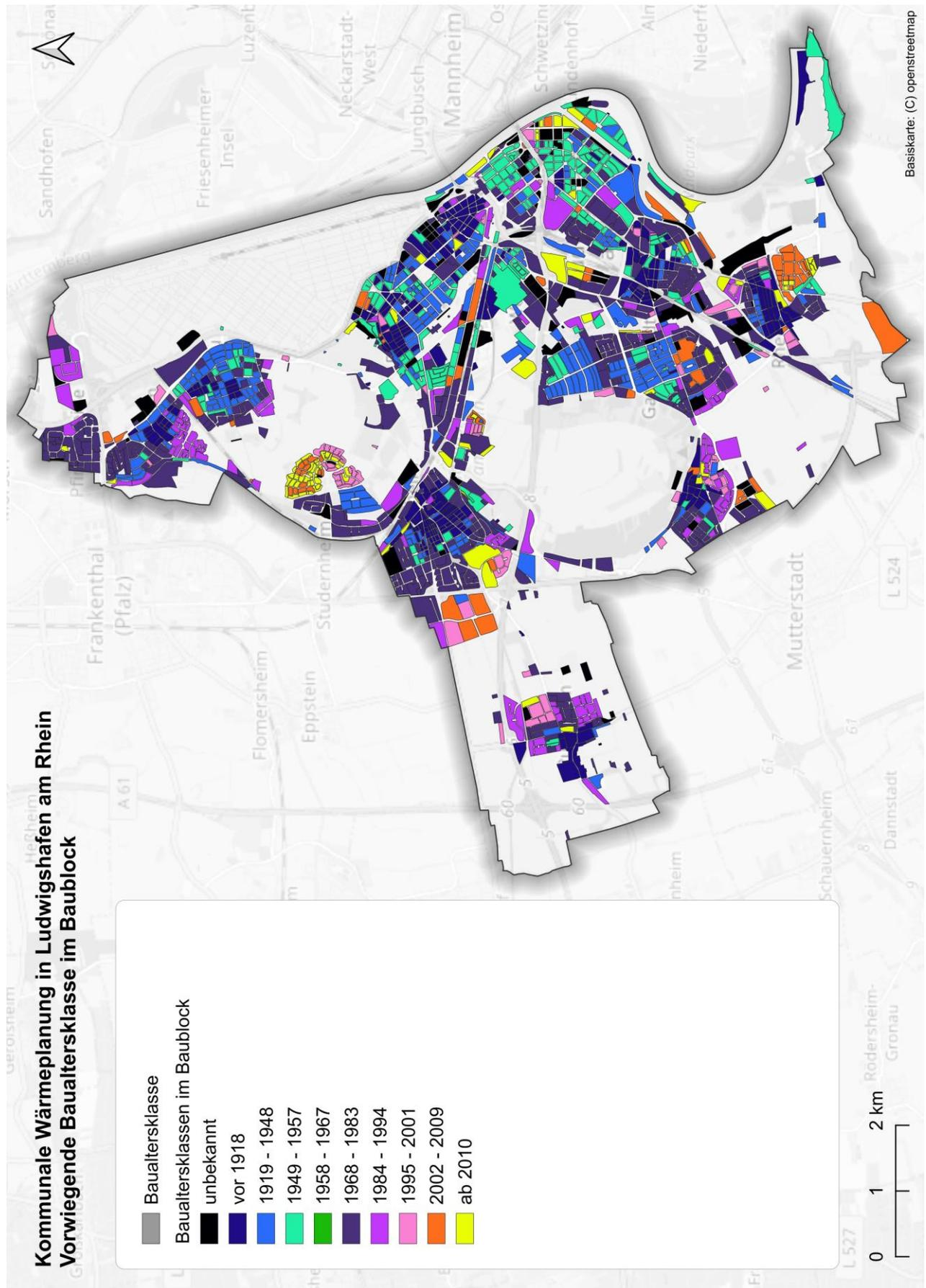
Abbildung 7: Vorwiegende Baualtersklassen nach Baublöcken
