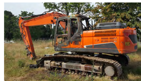
Ausgebrannter Bagger. Bei dem Brand gelangte Diesel und Hydrauliköl in das Erdreich. (Foto: Stadt Ludwigshafen, Bereich Umwelt)
