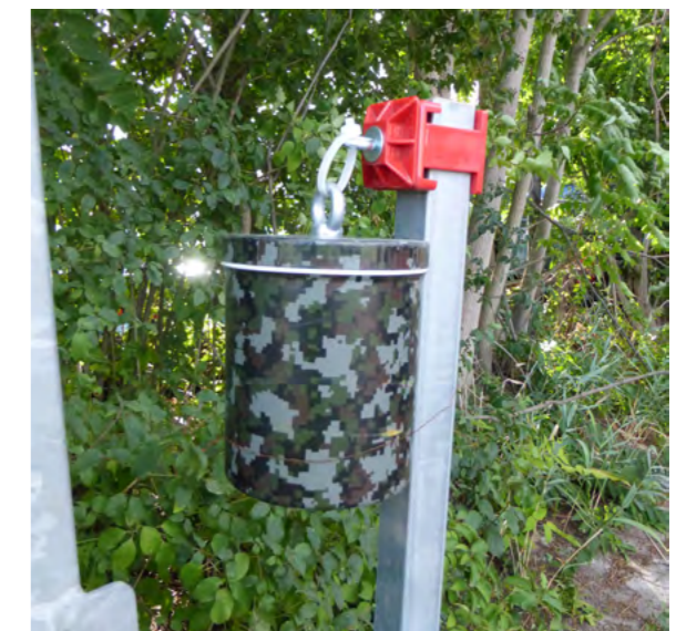
Umgebungsüberwachung Radon (Foto: SGD Süd)
