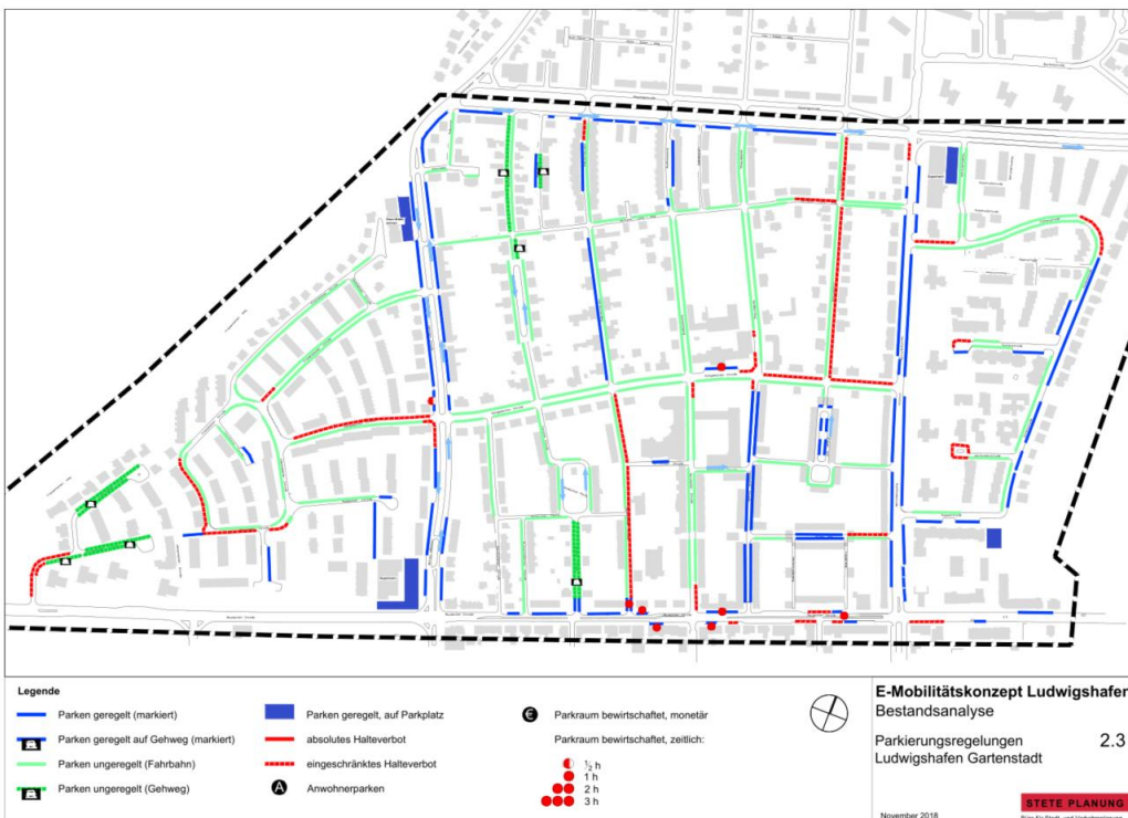
Abbildung 9: Bestandsaufnahme Parkierungsregelungen Gartenstadt
