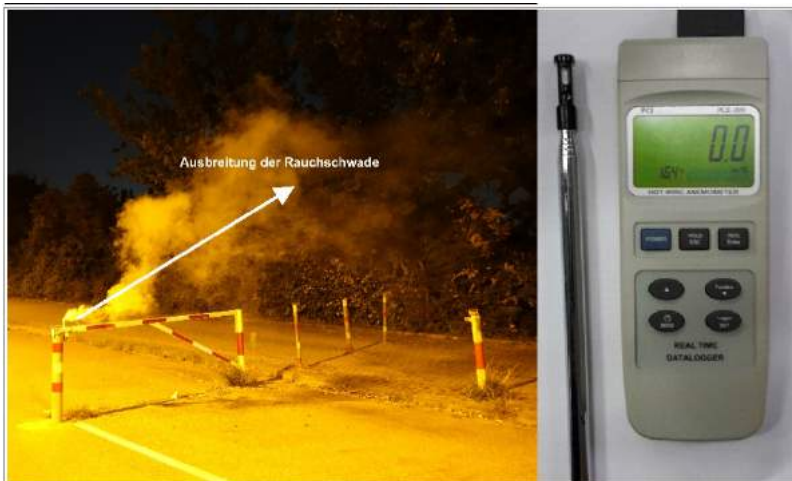
Abbildung 6: Rauchschwadenbeobachtung und Hitzdrahtanemometer zur Erfassung der bodennächsten Kaltluftbewegungen (Foto: ÖKOPLANA)
